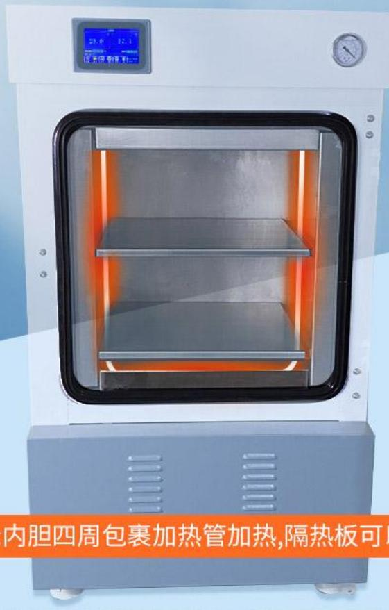
外加热:内胆四周包裹加热管加热,隔热板可以随意抽动
