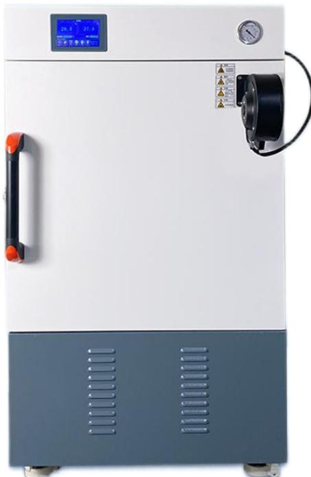
DZF-6210A 高温真空干燥箱可用于 400℃ 以下（常用建议 350℃ 以下）高温干燥，作为一款 216L 内容量的一款中型真空烘箱，其自身自带 10 段程控，支持程控和定值控温切换，定时 9999 周期（分钟/小时可切换），整体采用半自动真空表模式，304 不锈钢加热，分内/外加热两种款式（工业电压 380V），内加热采用 3 层单层 1500W 不可拆卸加热隔板，外加热采用内胆四周捆绑式 6000W 加热，微电脑 PID 温控，支持超温报警、超温报警、定时停机、来电恢复、参数加密、温度修正、转速修正等功能。
