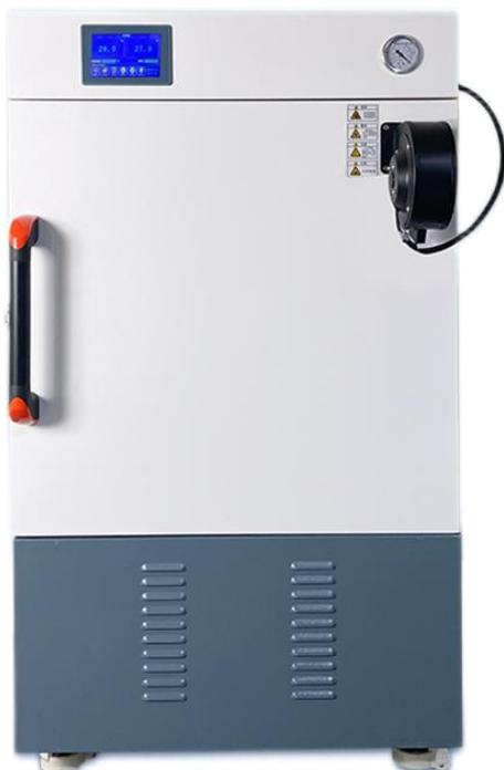
DZF-6120A 高温真空干燥箱是一款具备 125L 容量的一款高温真空烘箱，支持室温+100~400℃温控，采用半自动真空表模式，机械指针式真空表显示，可提前预设抽真空间隔时间，实现，产品分内/外加热两种款式，内加热采用 2 层单层 1200W 不可拆卸加热隔板，外加热采用内胆四周捆绑式 4800W 加热，采用工业电压 380V；微电脑 PID 温控，自带 10 段程控，支持定时 9999 周期（分钟/小时可切换）。
