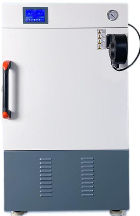
DZF-6070A 高温真空干燥箱拥有 72L 内容积，可用于 400℃ 以下（常用建议 350℃ 以下）高温脱泡，支持室温+100~400℃ 温控，采用半自动真空表模式，机械指针式真空表显示，产品分内/外加热两种款式，内加热采用 2 层单层 1000W 不可拆卸加热隔板，外加热采用内胆四周捆绑式 4000W 加热，支持家用电压 220V 和工业电压 380V 定制；微电脑 PID 温控，自带 10 段程控，支持定时 9999 周期（分钟/小时可切换）。
