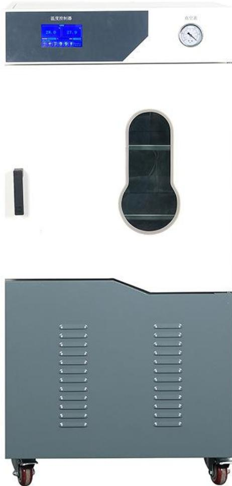
DZF-1000 立式真空干燥箱是一款大型大容量的立式真空烘箱，用于 1000L 大容量，采用外箱体采用冷轧钢板静电喷塑箱体，内胆采用 304 镜面不锈钢，该设备采用工业电压 380V，分内/外加热两款，内加热采用不可拆卸 5 层（每层 1200W）304 不锈钢加热隔板，外加热采用 9000W 内胆四周捆绑式加热，微电脑 PID 温控，自带 10 段程控或定值切换，支持 9999 周期（分钟/小时可切换），观察窗采用门上钢化玻璃加有机玻璃，可根据客户定制。
