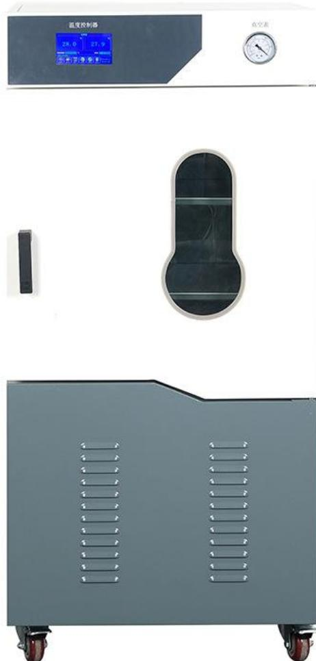
DZF-6250 立式真空干燥箱在 6210 的基础上进行了空间扩展，达到 250L 的容量，立式设计可极大缩小实验用地，半自动真空模式可自动实现抽真空间隔时间和真空泵启动时间的设置调整，极大方便人员操作，大容量设计，内加热采用不可拆卸三层（每层 900W）304 不锈钢加热隔板，外加热采用 4800W 内胆四周捆绑式加热（工业 380V 电压），微电脑 PID 温控，10 段程序控温，也可切换为定值控温，外加热有不锈钢加热管，四周环绕捆绑式内胆加热，可方便拆卸隔板。
