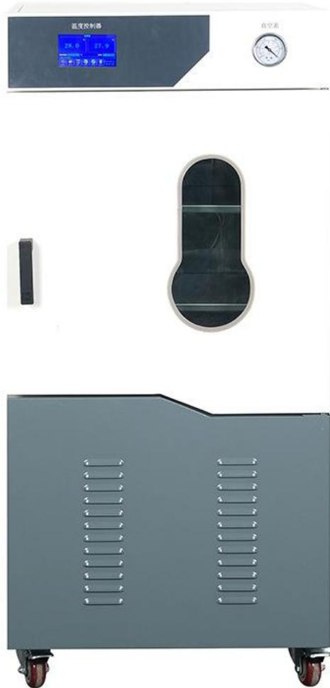
DZF-6210 立式真空干燥箱是一款 210L 内部容量的恒温真空箱，半自动真空模式可自动实现抽真空间隔时间调整，还可以定时调整真空泵启动时间，大容量设计可用于多种实验室样本干燥；作为一款中型真空箱，它分为内/外加热款式，内加热采用不可拆卸三层每层 800W 加热 304 不锈钢板，外加热采用 3600W 内胆四周捆绑式加热，微电脑 PID 温控，可实现定时升温，10 段程序控温，也可切换为定值控温，外加热有不锈钢加热管，四周环绕捆绑式内胆加热，可方便拆卸隔板。
